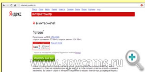
Нас интересует второй параметр - "**скорость загрузки**", который определяет скорость исходящего потока (отдачи). В данном примере этот параметр равен 5124 кбит/сек, что равняется точно 5 Мбит/сек (5124 надо разделить на 1024, чтобы привести к Мбит).
